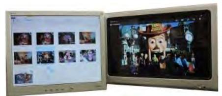
特に機器やアダプターを取り付ける必要もなく、液晶ディスプレイとケーブルがあればマルチディスプレイを構築できます。設定の「画面の解像度」ディスプレイ表示の変更→複数のディスプレイ→拡張する。
